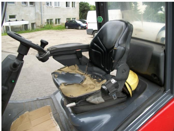
Siedzisko wózka jezdniowego podnośnikowego wymienione podczas kontroli inspektora pracy
