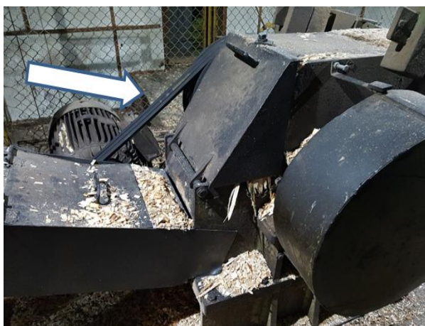
Niepełna osłona przekładni pasowej przy obrzynarko-wielopile typu DPPD50 oraz nieosłonięte paski przekazu napędu przy rębaku DDRBA.
