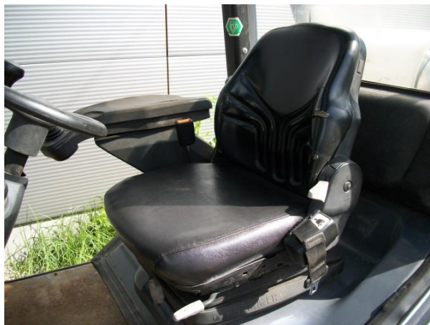
Siedzisko wózka jezdniowego podnośnikowego wymienione podczas kontroli inspektora pracy
