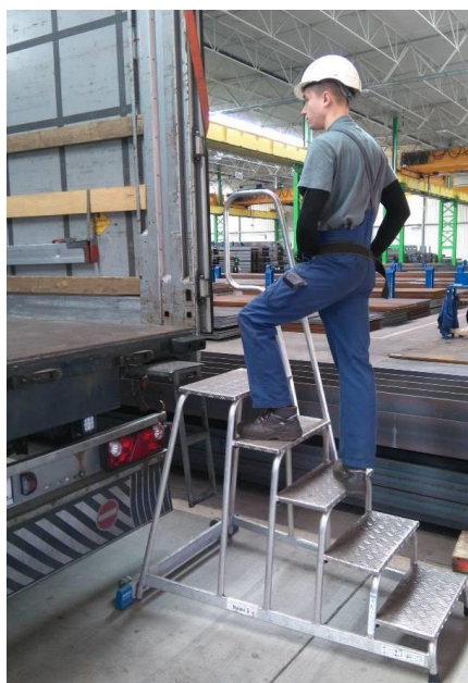
Pomost ze stopniami i poręczą, dostosowany do wysokości naczep.
