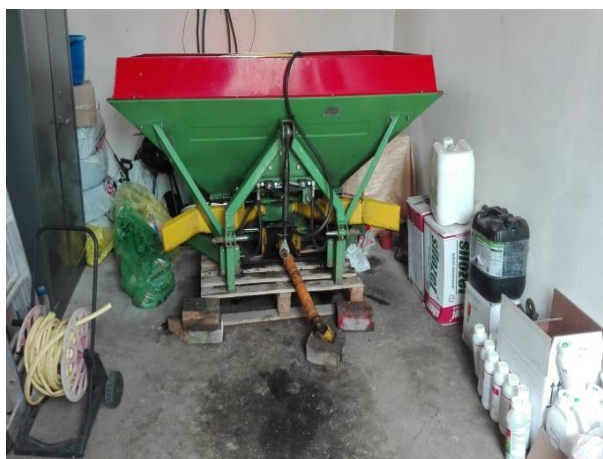
Brak osłony wału przegubowo- teleskopowego
