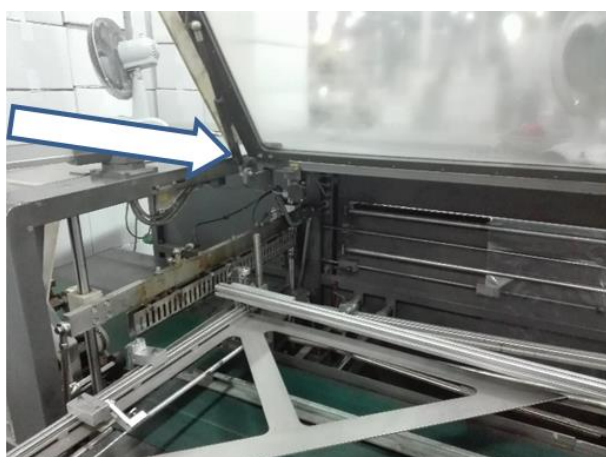
niesprawne wyłączniki bezpieczeństwa służący do blokowania uchylnych (ruchomych) osłony z tworzywa sztucznego maszyny pakującej – odczepione bolce od ww. osłon zostały na stałe wmontowane w gniazda wtykowe ww. przełączników bezpieczeństwa Stan taki powoduje, iż możliwe było wykonywanie niebezpiecznych funkcji ww. maszyny tj. ruch obrotowy części składowych modułu zgrzewającego przy otwartej osłonie. W ww. przypadku otwarcie (usunięcie) ww. ruchomej osłony stanowiącej urządzenie ochronne nie powodowało zatrzymania maszyny.
