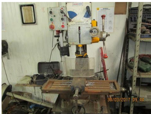
Brak osłony uchwyty wiertarskiego Zamontowana osłona uchwyty wiertarskiego
