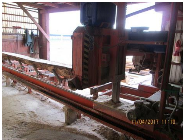
Brak wyposażenia maszyn stwarzających zagrożenie emisją pyłu, skutkujące leżącymi wokół pilarki taśmowej oraz pilarki tarczowej trocinami.
