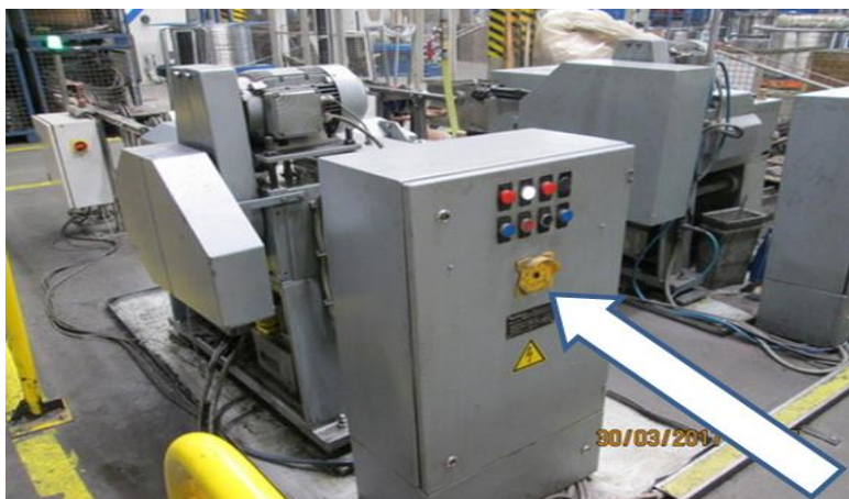
Brak łącznika do odłączania maszyny od źródła energii elektrycznej.
