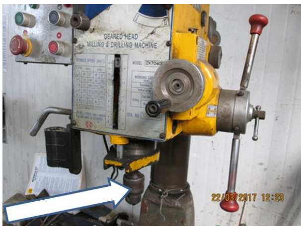
Brak osłony uchwyty wiertarskiego Zamontowana osłona uchwyty wiertarskiego
