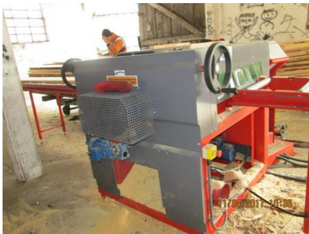
Brak wyposażenia maszyn stwarzających zagrożenie emisją pyłu, skutkujące leżącymi wokół pilarki taśmowej oraz pilarki tarczowej trocinami.
