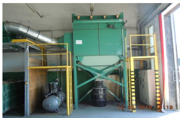
Rysunek 30 Tak jest. Sortownia odpadów komunalnych zmieszanych i selektywnie zebranych – separator powietrzny, Puszcza Miejska (foto. Puszcza Miejska, październik 2015r.)
