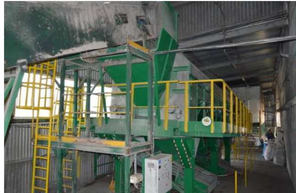
Rysunek 28 Tak jest. Sortownia odpadów komunalnych zmieszanych i selektywnie zebranych - sito bębnowe, Puszcza Miejska (foto. Puszcza Miejska, październik 2015r.)
