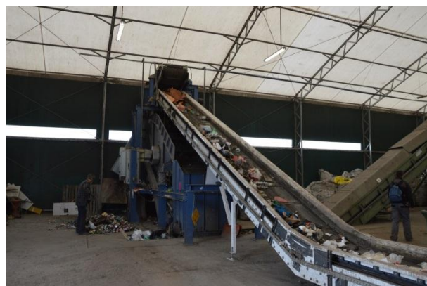
Rysunek 67 Tak jest. Sortownia odpadów zmieszanych i selektywnie zebranych- sito kaskadowe, Służewo (foto: Służewo, wrzesień 2015r)
