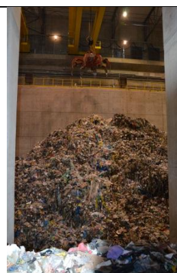
Tak jest. Spalarnia odpadów komunalnych, bunkier zasypowy odpadów, Bydgoszcz ProNatura ZTPOK (foto: Bydgoszcz, październik 2015r)
