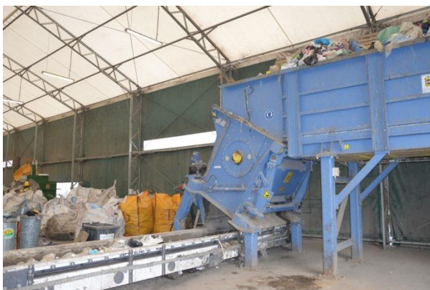
Rysunek 68 Tak jest. Sortownia odpadów zmieszanych i selektywnie zebranych- rozrywarka worków, Służewo (foto: Służewo, wrzesień 2015r)
