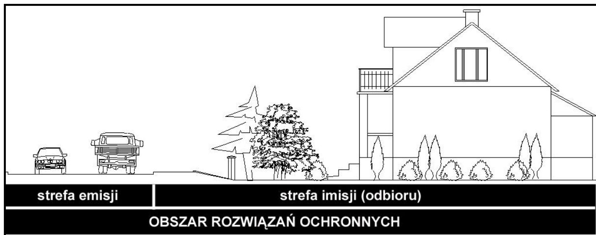
Rys. 1. Strefy emisji i imisji hałasu oraz obszar rozwiązań ochronnych w uniwersalnym podejściu do ochrony przed hałasem drogowym
