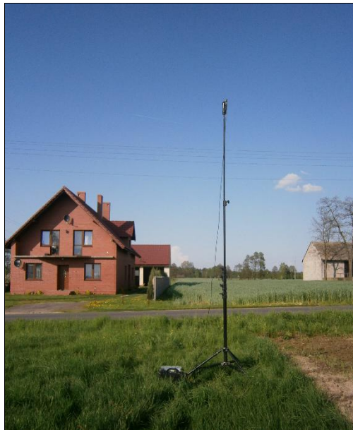
Zdj. Pomiar hałasu komunikacyjnego wykonywany na granicy chronionego terenu
