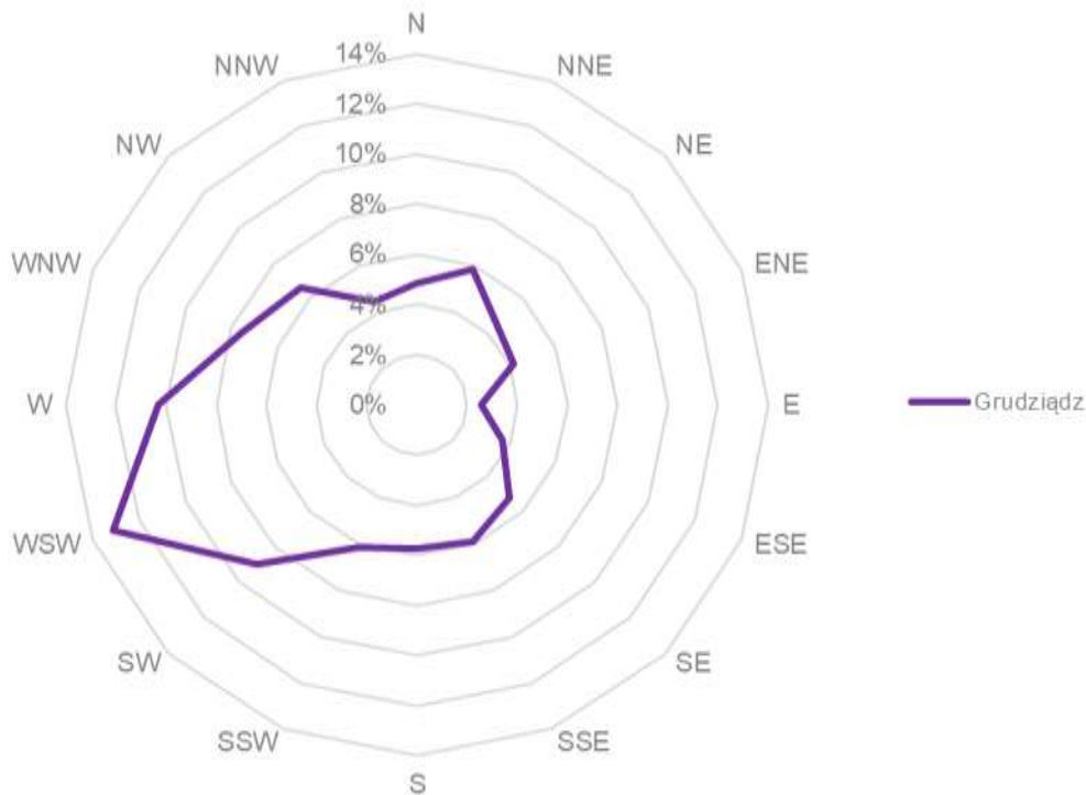
Rysunek 2. Róża wiatrów w strefie kujawsko-pomorskiej w 2021 roku, na podstawie danych wyznaczonych przez model WRF/CALMET dla Grudziądza
