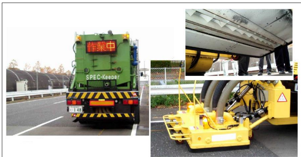
Rysunek 35. Sprzęt wykorzystywany przy oczyszczaniu nawierzchni z asfaltu porowatego
