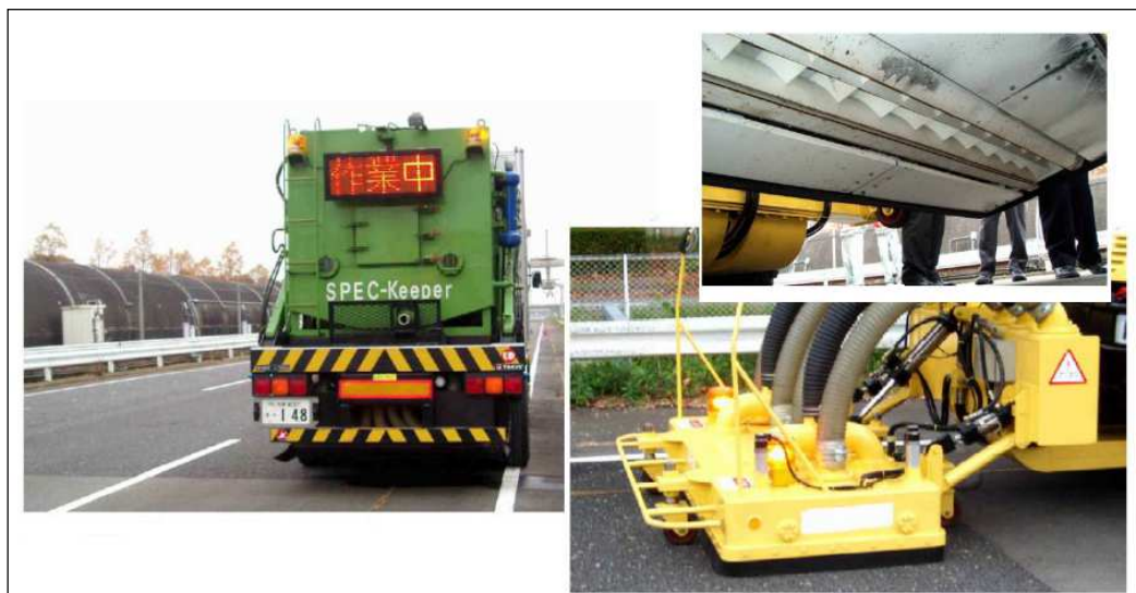
Rysunek 35. Sprzęt wykorzystywany przy oczyszczaniu nawierzchni z asfaltu porowatego [Źródło: Zastosowanie nowoczesnych technologii w konstrukcjach drogowych, Zakopane 15-17.09.2010 r.]
