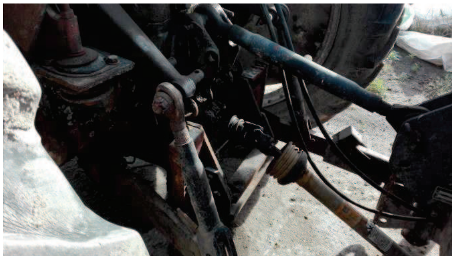
Wał przegubowo-teleskopowy z uszkodzoną osłoną
