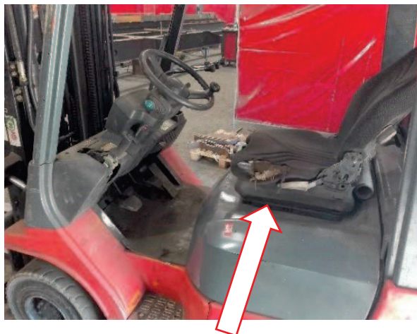
przy wózku jezdniowym podnośnikowym stwierdzono uszkodzone siedzisko operatora,
