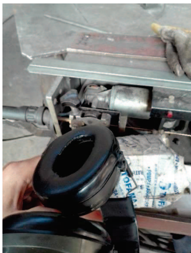
uszkodzone ochronniki słuchu
