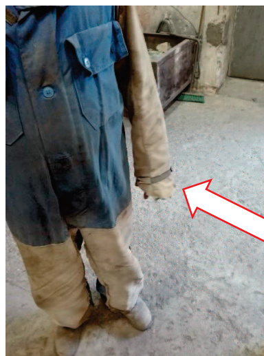
uszkodzony kombinezon ochronny pracownika wykonującego czyszczenie powierzchni metalowych metodą strumieniowo-ścierną,
