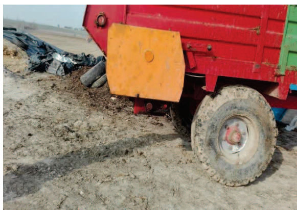
Fot.14 brak osłon rozrzutnika
