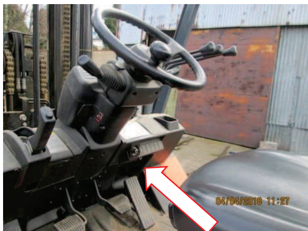
w stojącym na placu zakładu wózku znajdował się kluczyk w stacyjce, co umożliwiło użycie wózka przez osobę nieuprawnioną,
