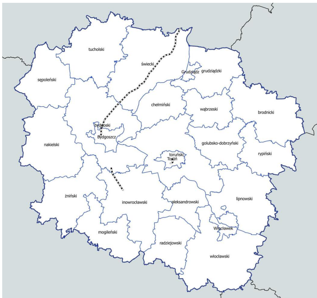
Rys. 2.2. Przebieg analizowanych odcinków linii kolejowych w województwie kujawsko-pomorskim o natężeniu ruchu ponad 30 000 pociągów rocznie
